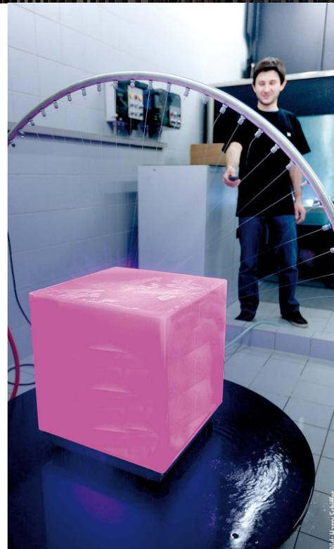
XALcc Nassraum: Hier wird ein Dichttest unter dem Spritzbogen durchgeführt.
