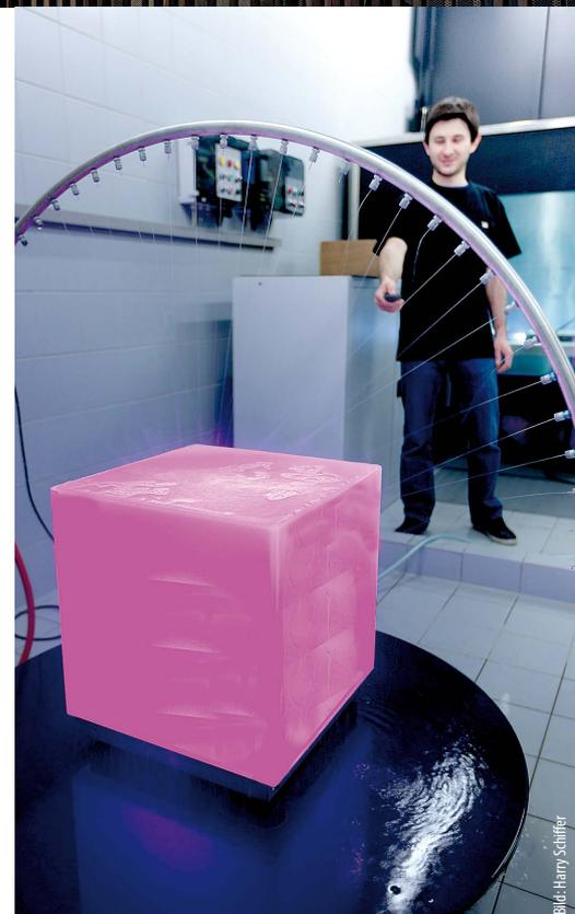
XALcc Nassraum: Hier wird ein Dichtheitstest unter dem Spritzbogen durchgeführt.
